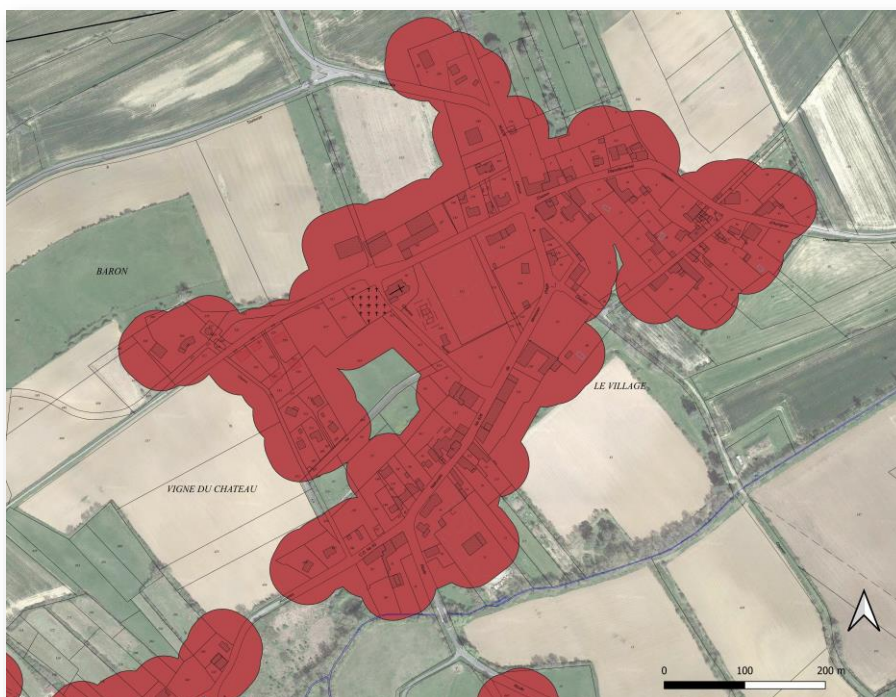
Figure 32 : Exemple de l'enveloppe urbaine du village après application d'une dilatation de 40 mètres comptée à partir du bâti / CEREMA
